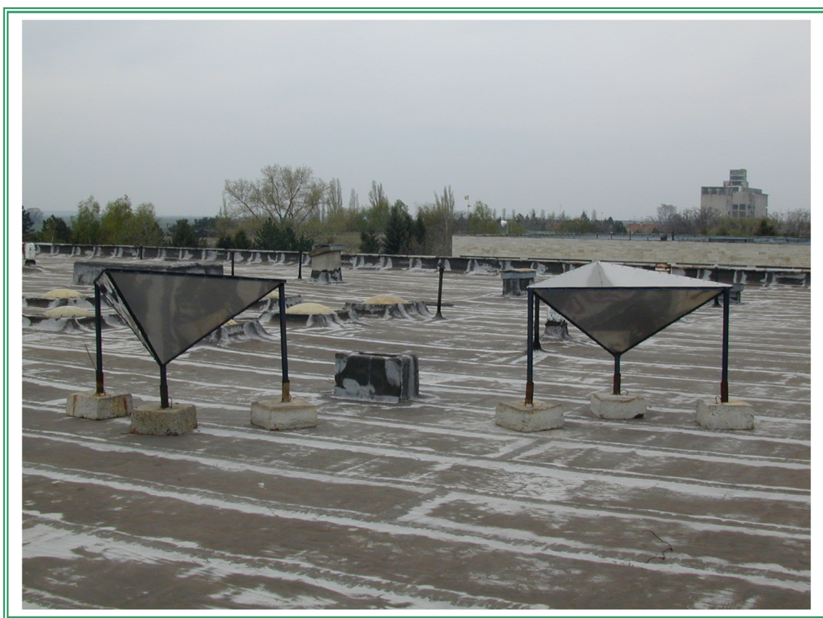
Figura 2 Triedre reflectorizante folosite ca ținte-etalon pentru calibrarea imaginilor radar
