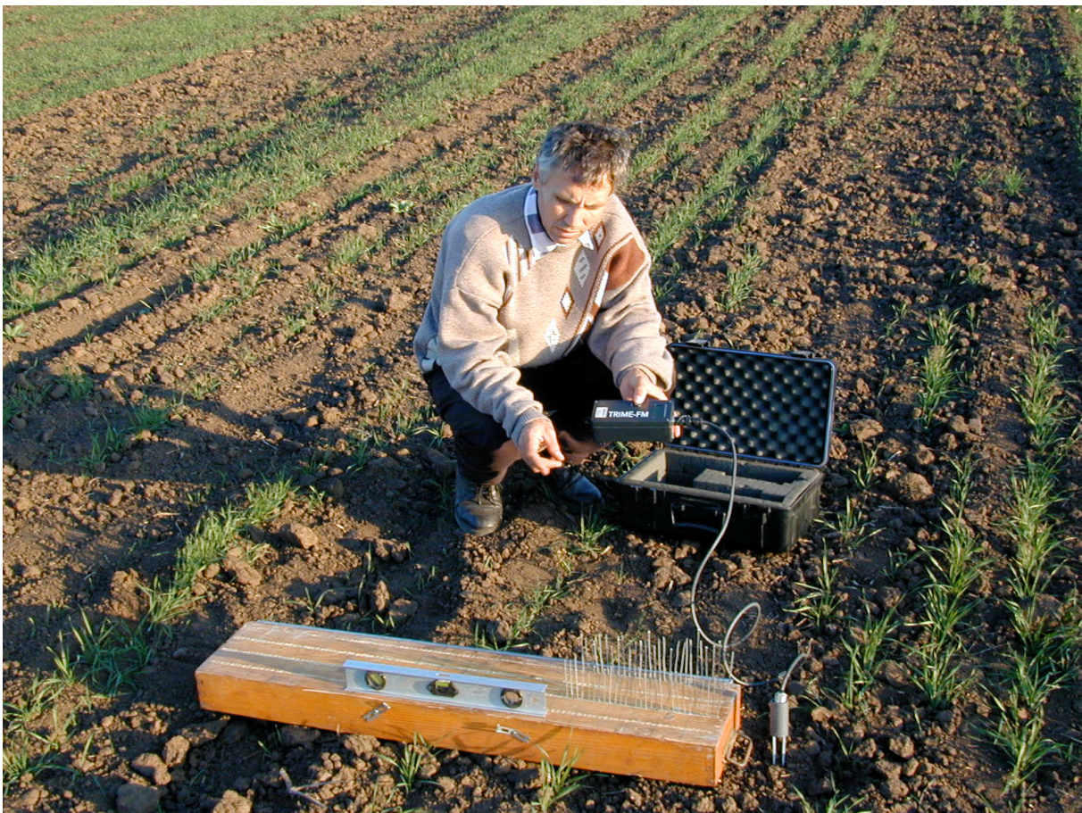
Schéma du dispositif de mesure de rugosité
